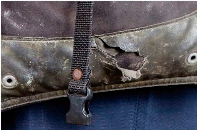
■ Figura 9 ■ Detalle de material de prenda de protección que precisa reparación
