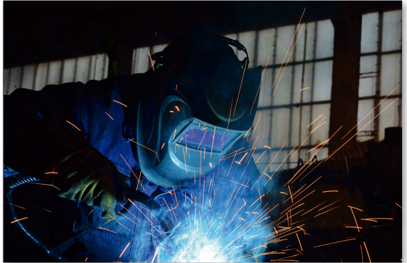
■ Figura 6 ■ Uso de ropa de protección junto con otros EPI compatibles en tareas de soldadura
