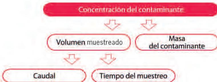
La **concentración del contaminante con captadores activos**, se obtiene mediante el cociente entre la cantidad de contaminante retenido (masa) y el volumen de aire muestreado, normalmente expresado en  $\text{mg}/\text{m}^3$ .
