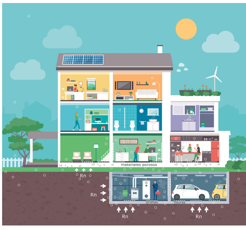
■ Figura 3 ■ Penetración del radón en los edificios
