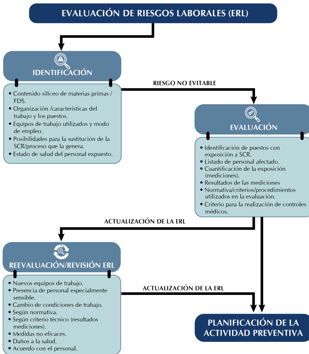
Fig. 9.2. Aspectos a documentar en la ERL, en relación con el riesgo de exposición a polvo de SCR (Fuente: INS)
