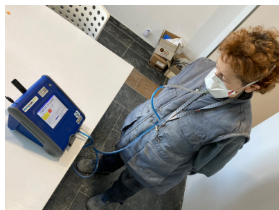
Fig. I.6. Trabajadora durante un test de ajuste cuantitativo por contaje de partículas (Fuente: INS)
