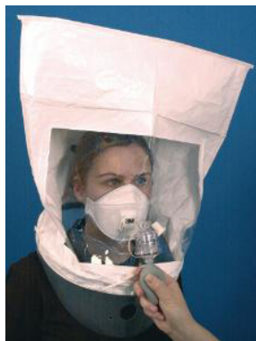
Fig. I.4. Test de ajuste cualitativo (Fuente: 3M)
