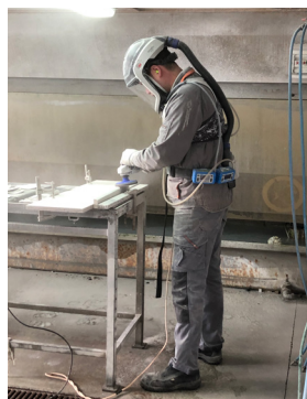
Fig. 6.9. Trabajador con EPR filtrante asistido (Fuente: INS)
