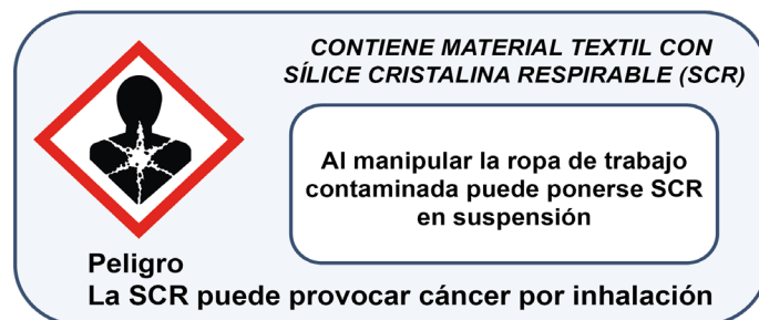
Fig. 6.2. Propuesta de etiqueta para señalizar recipientes que contienen ropa de trabajo con SCR
