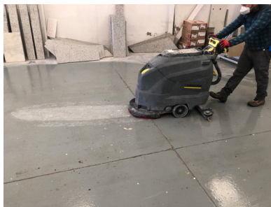
Fig. 6.3. Fregadora de suelos en marmolería (Fuente: INS)
