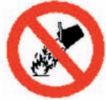
PROHIBIDO APAGAR CON AUGA
